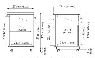
TBB-2SBD-N6 & TBB-2SGD-N SIDE VIEW
